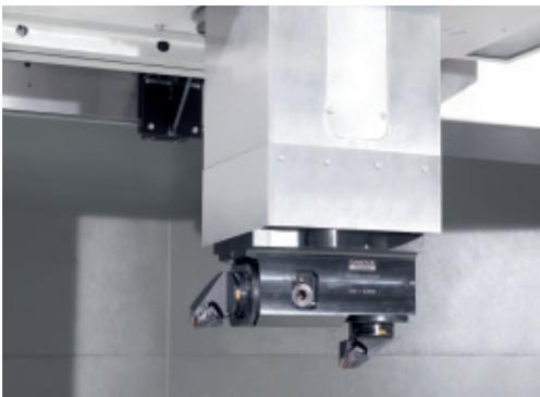
▲ Резцедержатели для инструментов модульной конструкции: Capto, KM...
