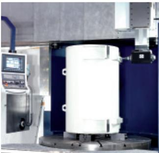
▲ Обточка / фрезеровка / сверление фланцев
