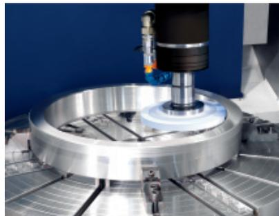
▲ Токарная обработка / сверление / фрезеровка корпусов генераторов
