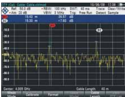
Измерение расстояния до места повреждения (DTF)
