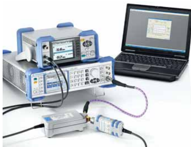
Измерительная установка для калибровки преобразователя мощности NRP-Z55
