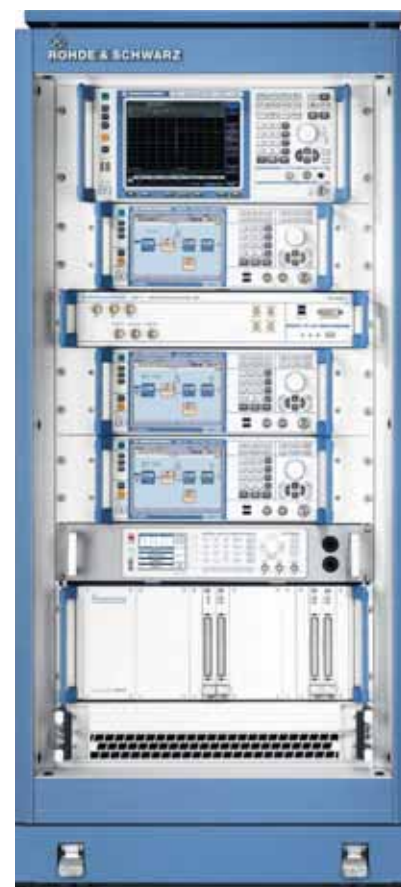
Пример конфигурации: трехканальная система для моноимпульсного радара.
