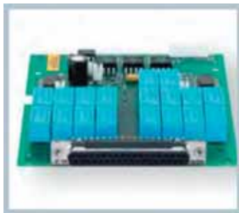
HM8112-3S: мультиметр с встроенным коммутатором каналов измерения (8+1 каналов, 2- и 4-проводных)
