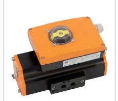
Эта прочная алюминиевая коробка переключателей применительна для прямого монтажа на пневмопривод в соответствии с VDI/VDE 3845. Различные конфигурации монтажной платы позволяют устанавливать внутри корпуса, как микропереключатели, так и бесконтактные выключатели различных типов.
