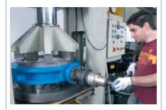
При сборке оператор проверяет герметичность всей собранной трубопроводной арматуры. Испытания на герметичность выполняются в соответствии со стандартом DIN EN 12266. Этот стандарт уже приведен в соответствие с Директивой по оборудованию, работающему под давлением, 97/23 EC. По запросу трубопроводная арматура может быть испытана на герметичность в соответствии с другими стандартами, такими как API 598, ISO 5208, и другими нормами и правилами.
