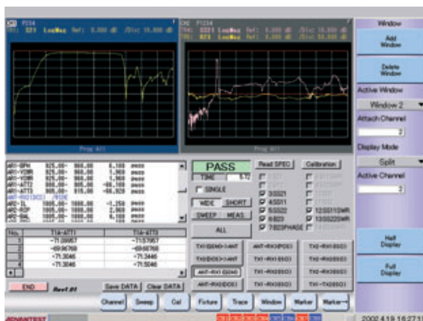
Рис. 4. Анализ модуля коммутации антенны мобильного телефона с помощью автоматической тестовой программы
