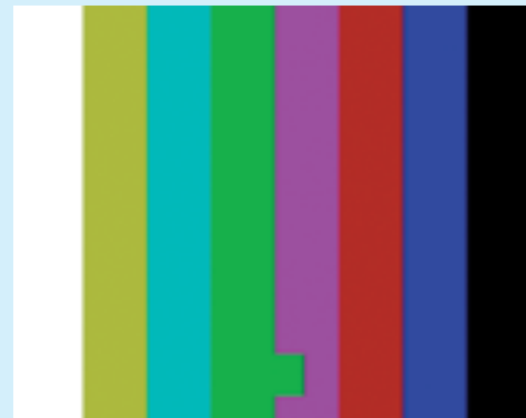
Тестовая таблица ITU-R BT.801-1 с движущимся элементом – для автоматической оценки качества изображения во время измерения EMS
