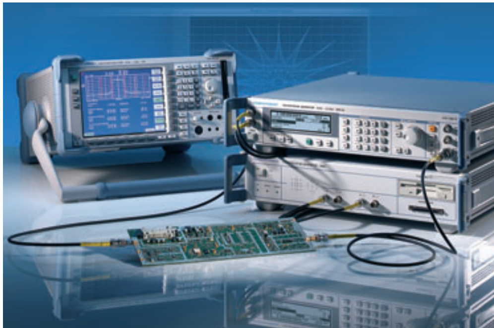
Рис. 1. Тестирование модуля с помощью R&S SMV03, R&S AMIQ и анализатора спектра R&S FSP
