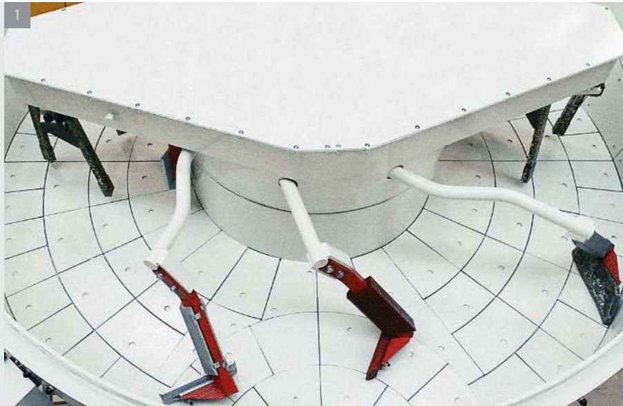
Вращение завихрителей осуществляется от главного привода смесителя. Для особых случаев частота вращения завихрителя может быть изменена путем замены шкивов ременной передачи. Также возможна, используя частотный преобразователь, регулировка частоты вращения редуктора и следовательно завихрителей, например, для операций заполнения и опорожнения.
