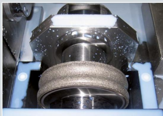
Инструмент для правки с профильным роликом
