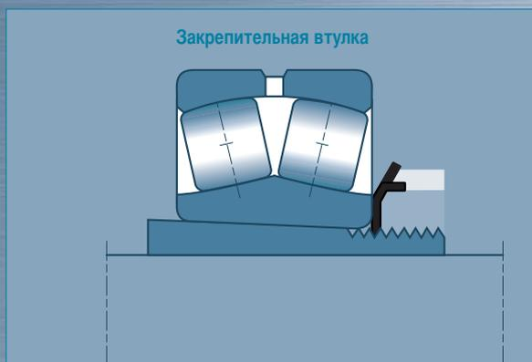
**Качество монтажа и затяжки имеет решающее значение для надежной и длительной работы подшипника.** Втулки позволяют устанавливать подшипники с коническим отверстием на цилиндрические валы с большими допусками на диаметр.
