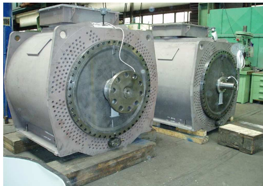
Асинхронный двигатель 3V200-14HV; 350kW, 400V, 423 об/мин, 50Hz, IM 1001, IP 54, IC 511, EExd IIBT4 3 шт., Škoda Praha, a.s., Кладно ГТ, Чешская Республика
