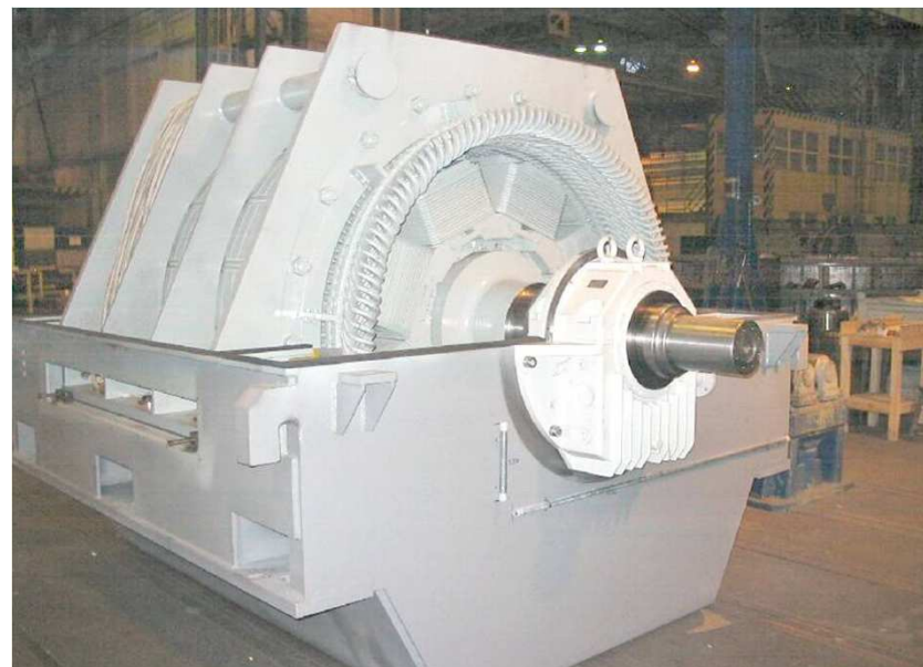
Синхронный генератор типа: 5A298 – 08Н, 10 000 kVA, 6 000 – 7 200 V, 750 – 960 об/мин., 50 – 64 Hz, IM 1001, IP 44, IC 37, 1 шт., Jetly Pruftechnik, GmbH, Германия/ Испытательный стенд трансформаторов, Сабуго, Португалия
