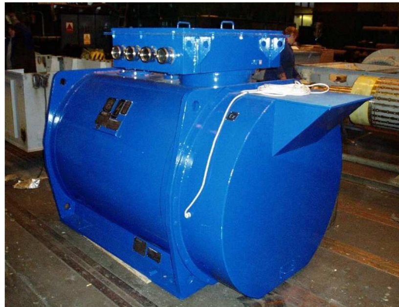
Асинхронный двигатель типа: 3V 170 – 02H, 1 000 kW, 690 V, 50 Hz, 2975 об/мин., IM 1001, IP 54, IC 511, EExd IIA T3 1 шт., ФГУП «ММП «САЛЮТ», Россия
