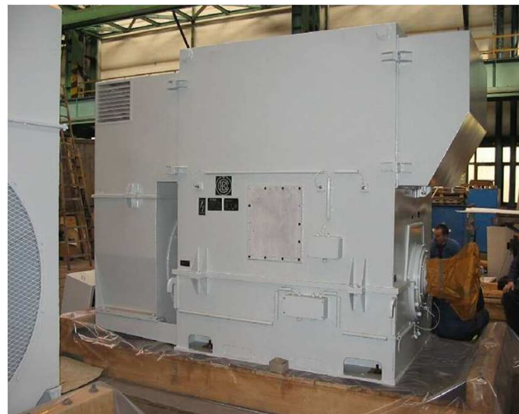
Асинхронный двигатель типа 5V 208 – 04HV, 3 000 kW, 6 000 V, 50Hz, 1489 об/мин., IM 1001, IP 55, IC 611 4 шт., Škodaexport, a.s. / ТЭЦ «Шен Тоу», Китай
