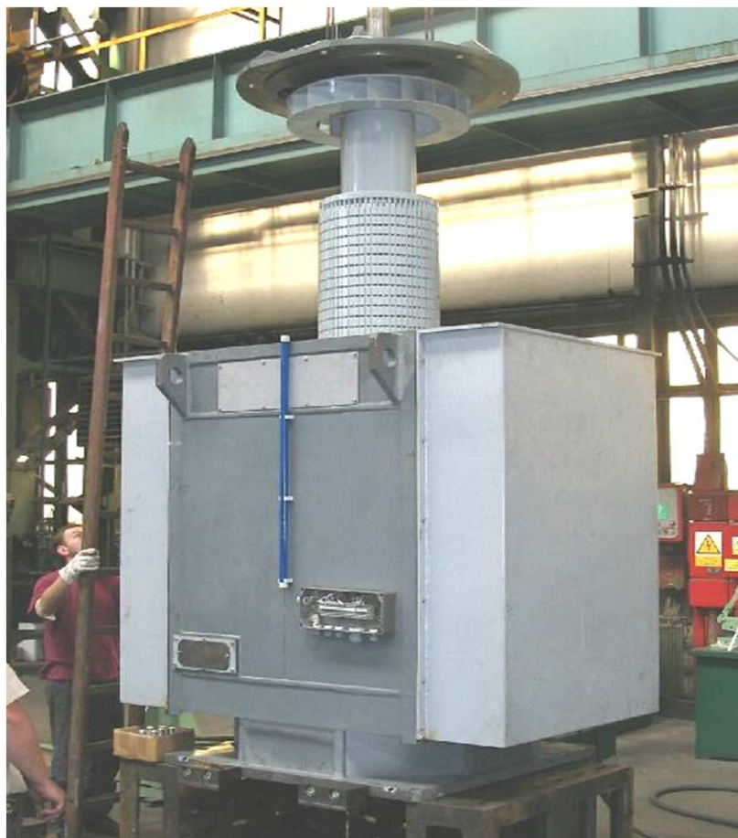
Асинхронный мотор типа: 5V 168 – 06VV, 550 kW, 10 000 V, 50 Hz, 990 об/мин., IM 3011, IP 55, IC 611 4 шт., Nijhujs Pompen, Голландия / «СВТП», Санкт-Петербург, Россия
