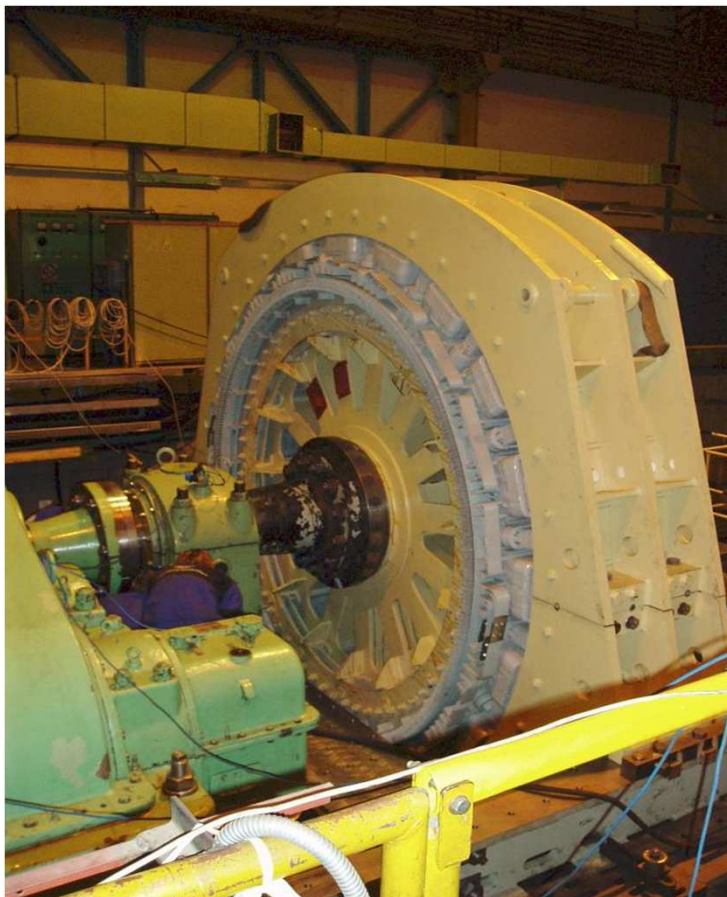
Двигатель постоянного тока типа: 2Q 446 – 20H4, 1 600 kW, 525 V, 3 350 A, 32 об/мин., IM 5510, IP 00, IC 17; 2 шт., INCO Engineering / ОАО «Апатит», Кировск, Россия
