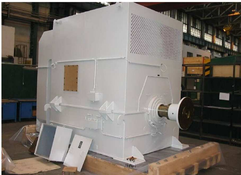
Асинхронный двигатель типа 5V 225 – 16HV, 2 200 kW, 6 000 V, 50 Hz, 372 об/мин., IM 7211, IP 54, IC 611 ZVVZ Milevsko, a.s. / ТЭЦ «Шен Тоу», Китай
