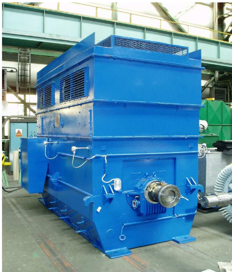
Синхронный генератор типа: 4A235 – 02H, 7 500 kVA, 10 500V, 3 000 об/мин., 50Hz IM 1001, IP 54, IC 31, бесконтактная система возбуждения, 4 шт., НПО «САТУРН», Россия
