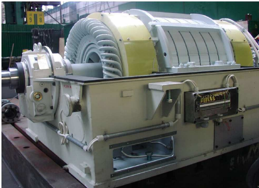
Асинхронный двигатель типа: 5V 162 – 02HW, 1 100 kW, 6 000 V, 50 Hz, 2983 об/мин., IM 1001, IP 44, IC 71W 16 шт., ЗАО «ОМЗ – НЕМО», Россия
