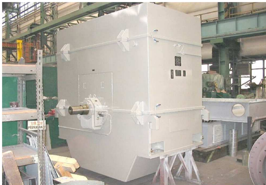
Синхронный генератор типа: 5A293 – 24Н, 2 500 kVA, 6 000 – 7 200 V, 750 – 900 об/мин., 150 – 180 Hz, IM 1001, IP 44, IC 37, 1 шт., Jetly Pruftechnik, GmbH, Германия/ Испытательный стенд трансформаторов, Сабуго, Португалия
