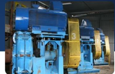
TRÓJFAZOWE SILNIKI KLATKOWE ŚREDNIEGO NAPIĘCIA 2000-6600V
