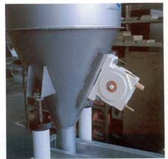
Bild 8 Hochfrequente Erregung eines Trichters
