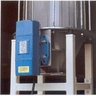
Bild 2 Vibrationsmotor HVL 3/2 als Auslaufaktivator
