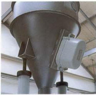
Bild 4 Erregung eines Trichters mit einem Vibrator EV 2 zur Vermeidung von Brückenbildungen
