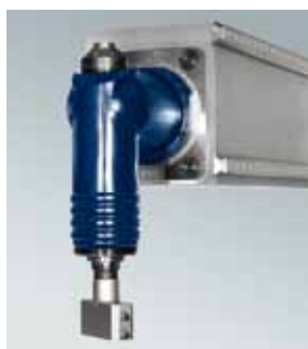
Угловая головка для обработки блока двигателя
