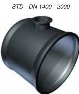
Особенность дренажного тройника с фланцевым ответвлением: геометрия соединения между ответвлением и корпусом тройника – специальной формы, позволяющей полностью опорожнять трубопровод.
