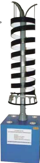
*Иллюстрация эластичности ВЧШГ: труба, разрезанная по спирали, превращается в пружину – упругую и эластичную.*
