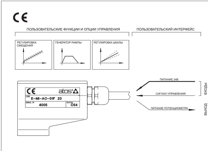
E-MI-AC усилители управляют питанием катушек пропорциональных распределителей Atos без преобразователей давления или положения, регулируя положение золотника, расход или давление в соответствии с сигналом управления.
