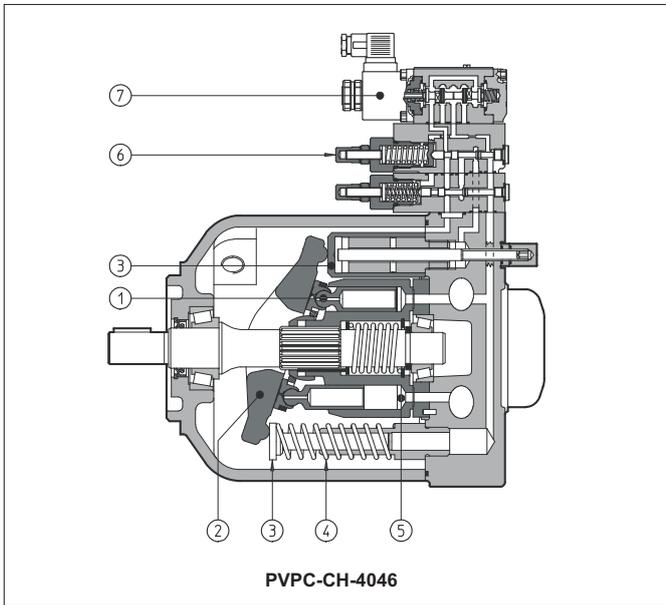
PVPC - это регулируемые аксиально-поршневые насосы, предназначенные для применения в системах с высоким рабочим давлением. Имеют низкий уровень шума и могут работать в системах с гидравлическими минеральными маслами или синтетическими жидкостями, имеющими аналогичные смазочные характеристики.
