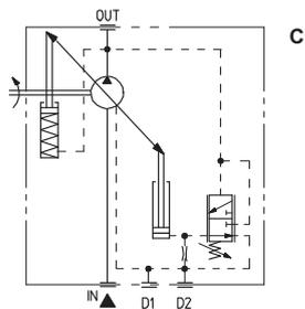
**Компенсатор давления с ручной настройкой**
