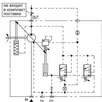
**LW Блок постоянной мощности**
