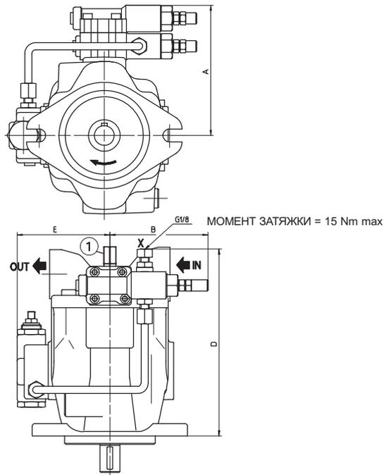
① = Винт ограничения максимального рабочего объема насоса. Диапазон настройки - от 50% до 100% от максимального рабочего объема.
