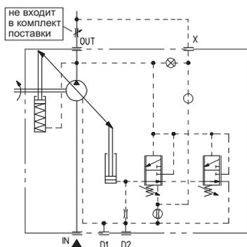
**Блок управления "load sensing"**
