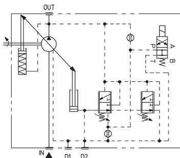
**SN Компенсатор давления с ручной настройкой и разгрузочным клапаном**
