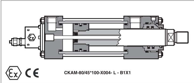
Цилиндры СКА являются расширением стандартной серии СК (табл.В137), плюс сертификация по АТЕХ 94/9/СЕ. Их конструкция позволяет ограничить температуру внешней поверхности согласно сертификату, для предотвращения самовоспламенения во взрывоопасной среде. Сервоцилиндры СКМ оборудованы встроенным взрывобезопасным цифровым магнитоотрикативным датчиком положения, сертифицированным по АТЕХ.
