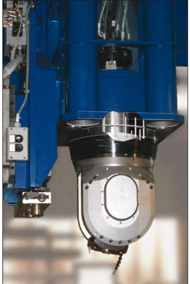
Einbaubeispiel eines S8-Gabelfräskopfes in einen vertikalen Maschinenschlitten
