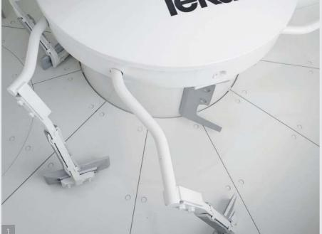
2 | Централизованная смазка втулок месильных рычагов возможно в специально
