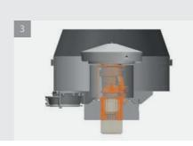
Общая система маслоснабжения облегчает технический уход за редуктором и системой
