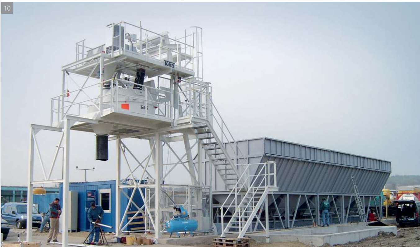
10 | TRANSMIX THZ 1500 - R 5 с линейным складом, 5 камер
