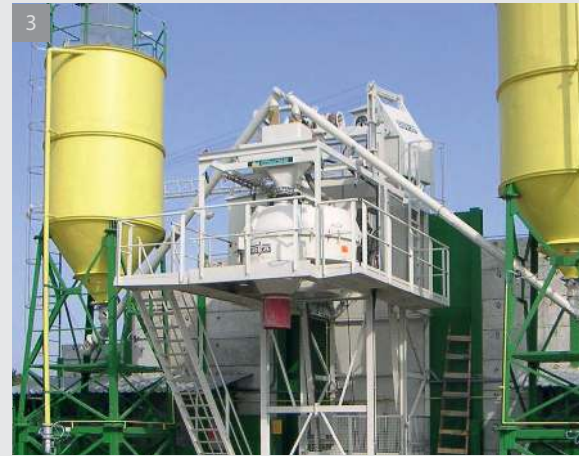
3 | TRANSMIX THZ 750 – S 4 установка с радиальным складом и ручным скреперным механизмом TS 12/13
