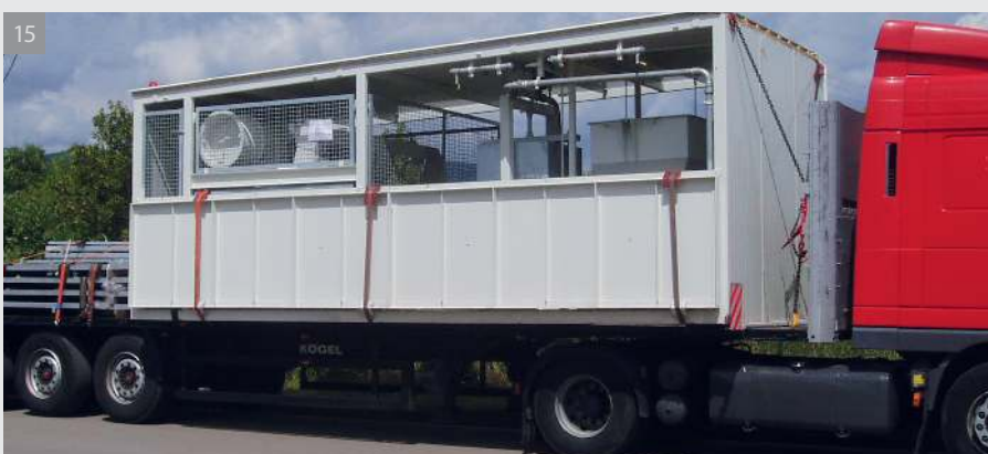
14-16 | Транспортировка модулей MIXOMAT THZ 3000-R 4/4 с нижней частью линейного бункера, весовой и смесительной платформами.
