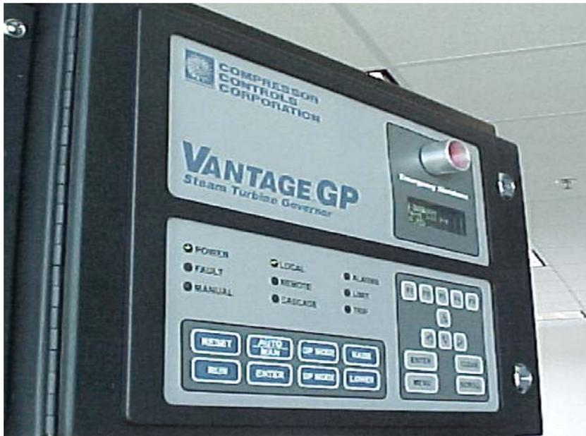
Специализированный цифровой регулятор для универсальных паровых турбин
