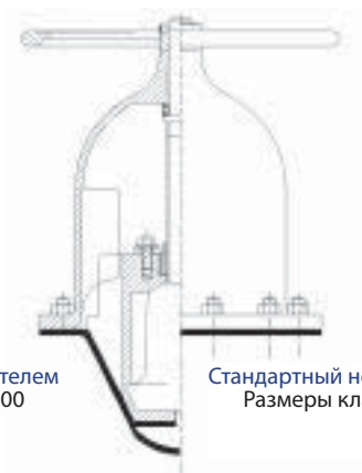
Индикация состояния клапана на выдвигающемся маховике Размеры клапанов: DN65 – DN150
