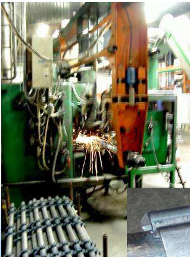
Сплав соединений при 44000 – 46000 Ампер
