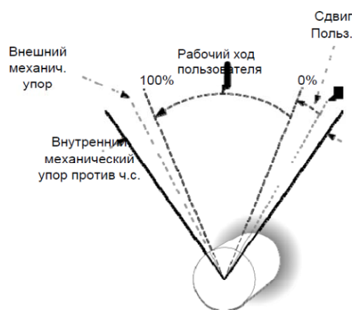
Диаграмма 5-19b. Настройки упоров при работе против часовой стрелки
