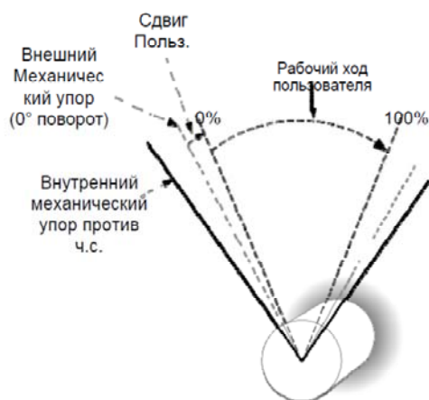
Диаграмма 5-19a. Настройки упоров при работе по часовой стрелке
